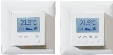
Raumfeuchte- Temperaturfühler inkl. Grafikdisplay mit weisser Hintergrundbeleuchtung, 3 oder 4 Funktionstasten mit Präsenz, Sollwertgeber, Stufenschalter A-0-1-2-3, Soll-Istwertanzeige (ab Version 1.7), Kommunikation über RS-485 Schnittstelle mit S-Bus (Data Mode).
